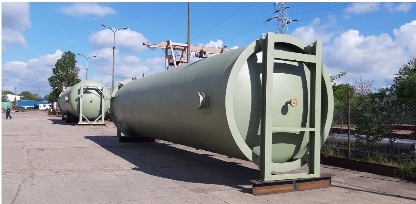
Zbiorniki magazynujące energię cieplną
